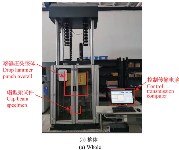
图 2 动态三点弯曲试验装置结构图
